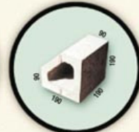
MA 190 Sill 7.82Kg 5/m 7Mpa
